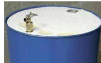
Rozwiązanie: Osłona sorpcyjna założona na pokrywę. Brak śladów skapnięć z pompy i brudnych szmat.
